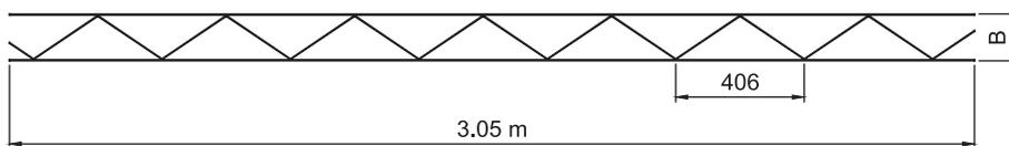
SIFMAFOR ist ein vorgefertigtes Bewehrungselement für bewehrtes Mauerwerk. Sigmafor wird aus verzinkten Stahldraht gefertigt und besteht aus parallel verlaufenden Längsstäben, die durch Punktschweißen an einem diagonal verlaufenden Dreht befestigt sind. Sigmafor erhöht die Tragfähigkeit des Mauerwerks und vermeidet Rissbildung.
