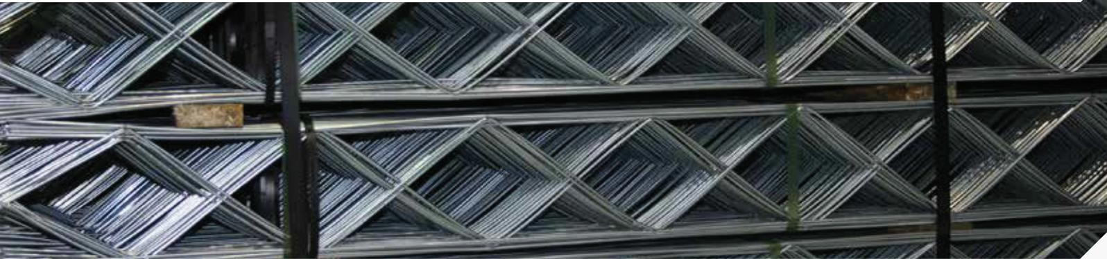
Sigmafor flach wird für Dünnbettmörtelfugen benutzt.
